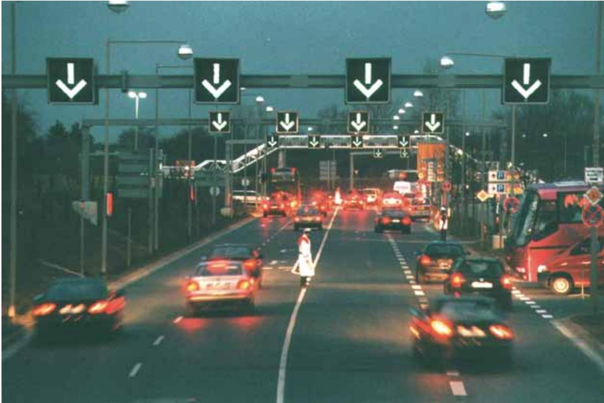
Abb. 62 Beispiel für den Einsatz einer Fahrstreifensignalisierung bei Großveranstaltungen (Abreise von einer Messeveranstaltung)
