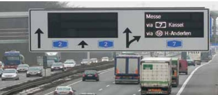
Abb. 58 Beispiel für Anzeigeoptionen an einer dynamischen Texttafel an Autobahnen
