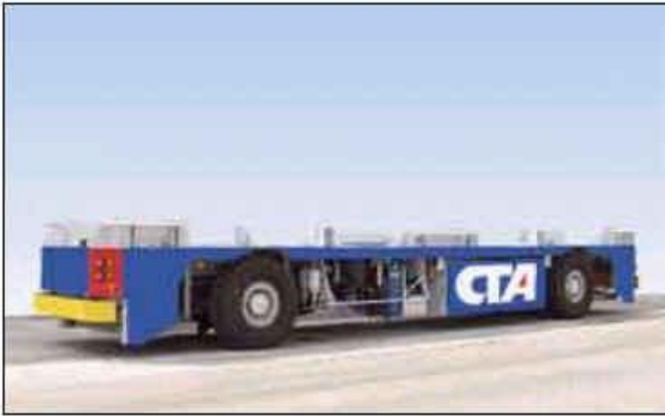
Abb. 9: AGV, Baujahr 2001: Das "CTA" am Fahrzeug steht für "Container Terminal Altenwerder".
