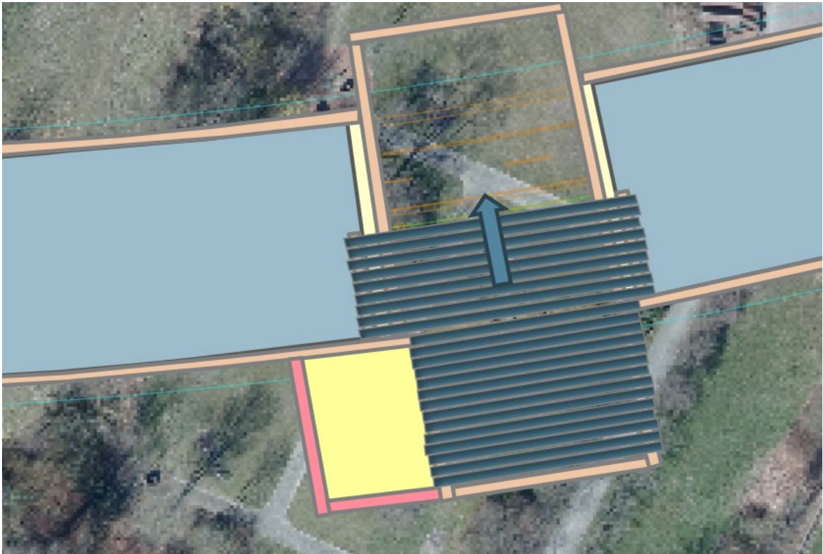
Abbildung 39: Rohrschirmdecke zur Abfangung der Gräber
