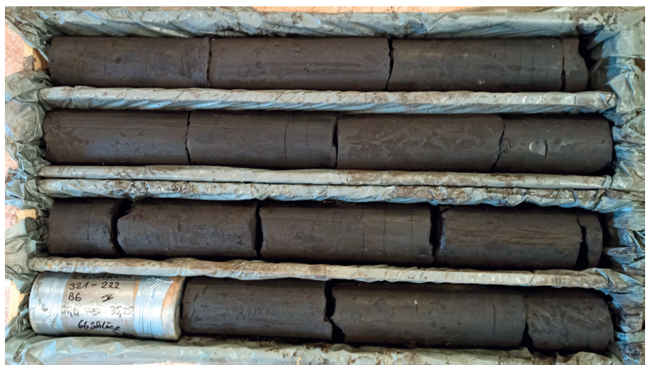
Abb. 8: Bohrkerne aus dem Oberen Glimmertone
