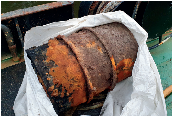
Abb. 2: Geborgener Schrott aus der Süderelbe, als Tarnnebelfass fehlinterpretiert Quelle: Patzold Köbke Engineers
