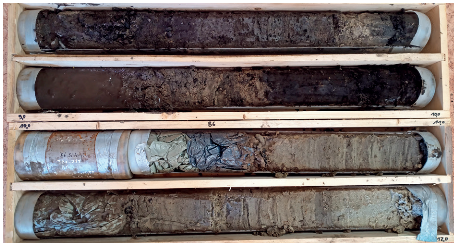
Abb. 5: Bohrkerne EÜ Süderelbe zwischen 8 und 12 m Tiefe, v. l. o. nach r. u.: Klei und Torf, Sonderprobe in Stahlhülle, sandiger Klei, Flusssande (ganz rechts unten). Fehlstellen mit Plastikfolie aufgefüllt
